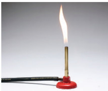
Llamas del mechero de Bunsen (amarilla luminosa, con entrada de aire cerrada y celeste transparente, con entrada de aire abierta).
