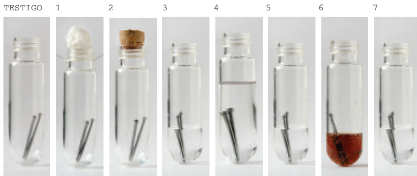
Tubos de ensayo con clavos de hierro durante el proceso de corrosión.
