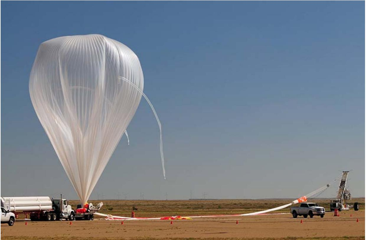
Preparación de lanzamiento de un globo de investigación de gran altitud, plataforma aplicada en la misión CiS RB-3. [Imagen](#) dominio público de Jet Propulsion Laboratory (NASA)
